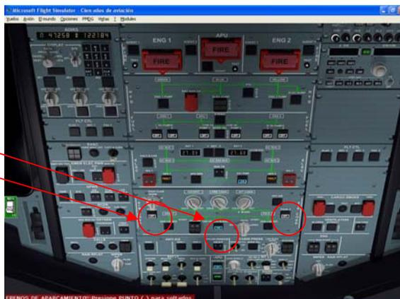
En general sabrás que todo está puesto correctamente cuando todas las luces en el panel superior están apagadas. En la sección FUEL las bombas de gasolina mostrarán “OFF” y las otras dos luces restantes GEN1 y GEN2 dirán FAULT en ámbar, esto se debe obviamente a que no están trabajando los motores aún.
