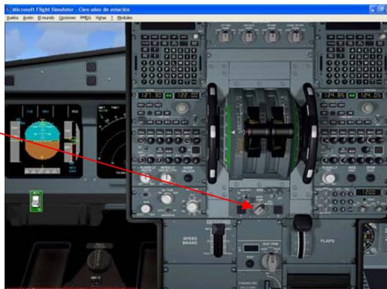
El arranque inicia automáticamente, una vez que el motor está trabajando. Cierra la consola central para ver el arranque del motor en el ECAM del panel del IFR (Shift + 4), entonces regresa a la consola central (Shift + 4).
