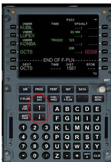
Para comprobar que la ruta es correcta y que no has introducido otros puntos de referencia por error, **selecciona "PLN" en el panel EFIS** y una escala de 160 o 320 (según lo requieras) y entonces **desplázate sobre la ruta hacia arriba o hacia abajo usando las teclas del MCDU (Flechas)**, para ver que tal se ve. El plan debe ir básicamente en la misma dirección. Si no es así, un punto deberá estar interfiriendo.
