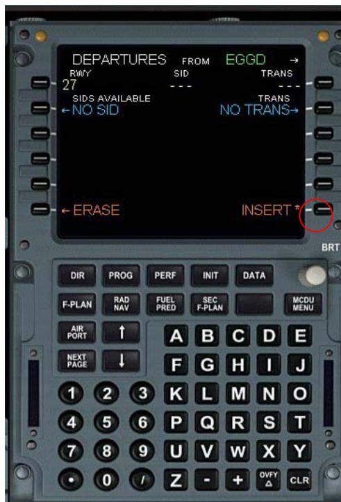
Debido a que no existe una SID (Standard Instrument Departure) seleccionada, El Airbus por defecto fijará una pendiente segura de ascenso sobre la pista hasta los 1500 pies AGL . EGGD está a 622 pies AGL. Mostrando por lo tanto un punto flotante con la identificación “2122”.
